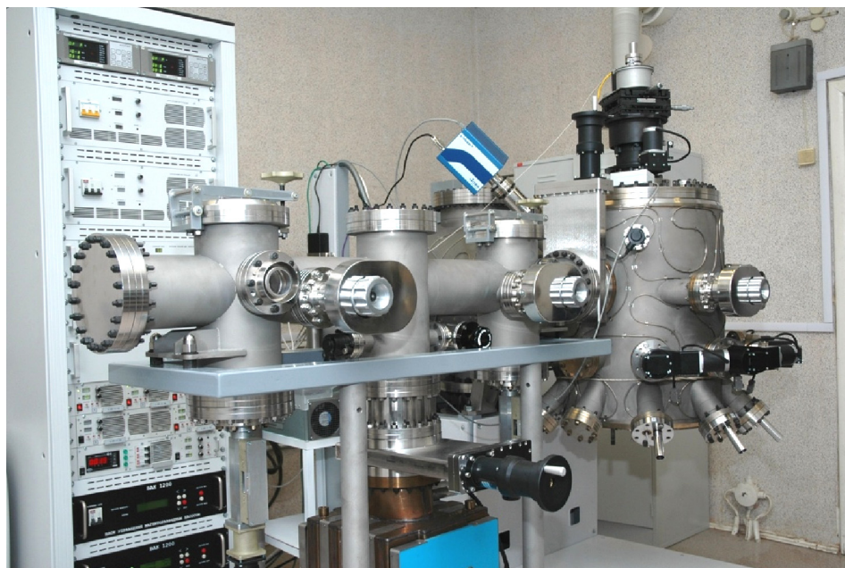
Рис. 44. Принципиальная схема установки молекулярно-лучевой эпитаксии (а) и внешний вид (б) автоматической сверхвысоковакуумной установки нового поколения для молекулярно-лучевой эпитаксии полупроводниковых многослойных гетеронаноструктур «Катунь 100»
