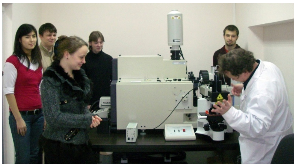
Рис. 107. Доктор физ.-мат. наук В. А. Володин (справа) демонстрирует возможности спектрометра комбинационного рассеяния света Т64000 (в центре) в ЦКП «ВТАН» НГУ студентам физического факультета НГУ
