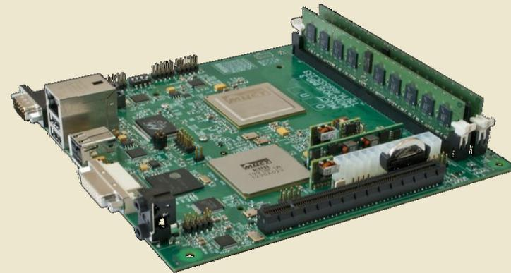
Компактная материнская плата «Монокуб-М», ядро которой — процессор «Эльбрус-2СМ», производимый АО «НИИМЭ» и ПАО «Завод «Микрон» по технологии 90 нм.
