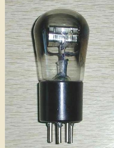
Прямокальный триод УБ-110, широко применявшийся в приемной аппаратуре начала XX века с поперечным расположением прямоугольного анода. Напряжение накала — 2 В.
