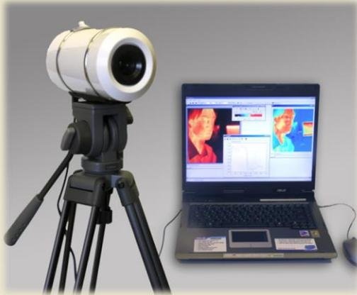
**Назначение:** медицинская, научная термография на основе дистанционного измерения распределения температуры по поверхности объектов.
