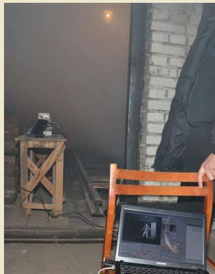
Разработана серия устройств на основе неохлаждаемых матричных микроболометрических приемников: тепловизионная камера с расширенными функциональными возможностями и с выводом изображения на малогабаритный жидкокристаллический экран форматом 2х3 см; опытный наשלмный прибор для регистрации изображений в условиях ограниченной **ВИДИМОСТИ**
