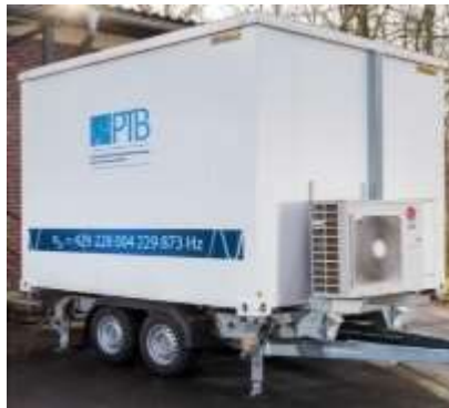
оптический КСЧ на основе холодных атомов стронция (РТВ)
